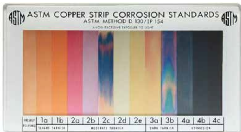
Rysunek 7. Wzorec korozji płytek miedzianych
