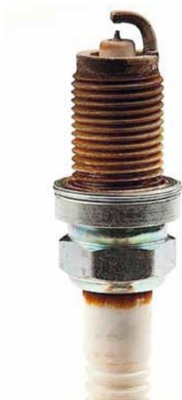
Rysunek 5. Czerwono-brunatny osad tlenku żelaza na świecy zapłonowej Źródło: Markel A.: A Closer Look At Spark Plugs. Underhood Service , Jul 17, 2015, https://www.underhoodservice.com/a-closer-look-at-spark-plugs
