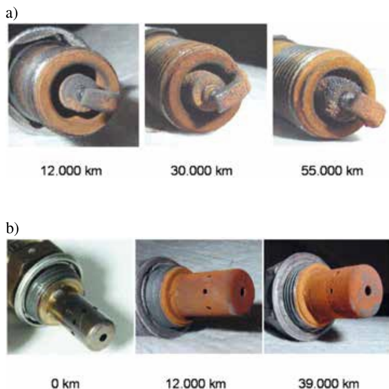
Rysunek 4. Osady tlenku manganu na: a) świecy zapłonowej, b) sondzie lambda
